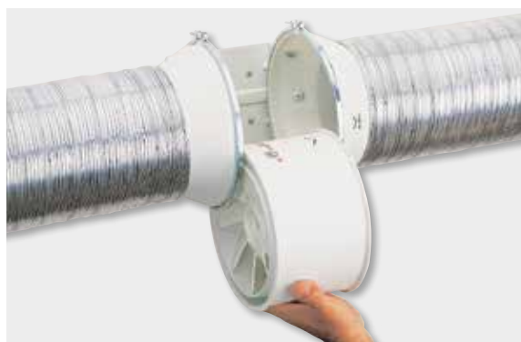
Dankzij het unieke ontwerp van de steunbeugel kan de motor en waaier geplaatst of verwijderd worden zonder de aangrenzende leidingen uit te bouwen.
