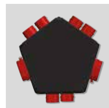
PLENUM UNI EXT 6+1 Geïsoleerd afzuigplenum met een diameter van 125/150-160 mm, 1 aansluiting met een diameter van 125 mm voor de keuken en max. 6 aansluitingen met een diameter van 80 mm voor sanitaire voorzieningen.
