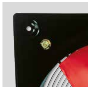
Corrosiebestendigheid Montageplaat, motorsteen en beschermrooster, beschermd door kataforese grondlaag Afwerking met zwarte polyester verflaag. Roestvrij stalen schroeven.
