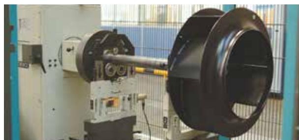
Waaier met achterover gebogen schoepen Om vuil- of vetophoping te voorkomen (ISO 1940 standaard).
