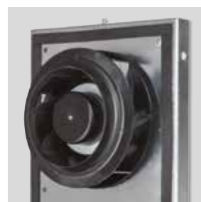
Waaier met achterover gebogen schoepen Om vuilophopingen te voorkomen. Dynamisch uitgebalanceerd. Waaier van kunststof voor maten 180 en 200, aluminium vanaf grootte 225.
