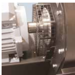
Standaardmotor met koelwaaier.
