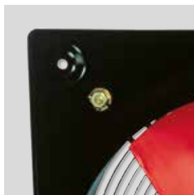
Corrosiebestendigheid! Montageplaat, motorsteun en beschermrooster, beschermd door kataforese grondlaag. Afwerking met zwarte polyester verflaag. Roestvrij stalen schroeven.
