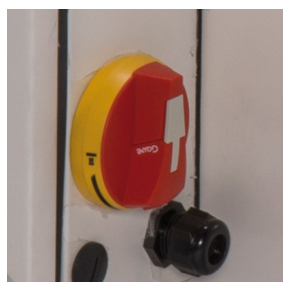
Veiligheidsschakelaar Alle uitvoeringen en modellen zijn voorzien van een Aan/ Uit-veiligheidsschakelaar.
