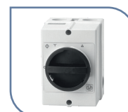
COM D/S Commutateur \lambda / \Delta Permet d'obtenir une seconde vitesse quand il est raccordé à un moteur triphasé 400V.
