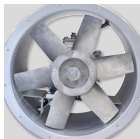
Hélice équilibrée dynamiquement Hélice d'une seule pièce à pales fixes en aluminium. Equilibrage selon la norme ISO 1940, pour un fonctionnement sans vibrations.
