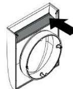
Krok 3: Otoče klapku, tak aby pružné těsnění do sedlo na čelní stěnu.
