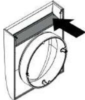
Paso 3: Presione la solapa hacia la espuma flexible hasta que se ajuste correctamente.
