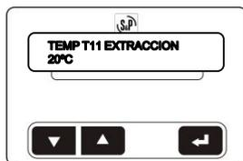
Temperatura sonda extracción:
