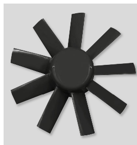
Hélice équilibrée dynamiquement Selon la norme ISO 1940, pour réduire le bruit et éviter les vibrations.
