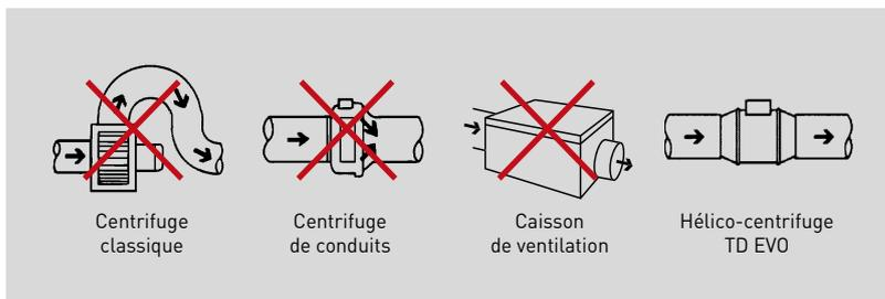
La hauteur réduite de la série TD EVO est la meilleure solution pour les installations où l'encombrement est limité comme dans les faux-plafonds.
