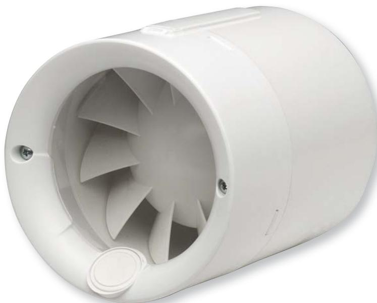
Extracteurs axial de conduit de très faible niveau sonore. Corps et hélice en polypropylène injecté. Clapet anti-retour. 2 passages de câbles possibles d'alimentation pour une installation plus facile. Température maxi de l'air ambiant: 40°C.
