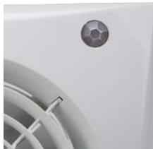
Modèle équipé avec un détecteur de présence par infrarouges. L'appareil se met en fonctionnement de manière automatique lorsqu'il détecte un mouvement, à une distance de 4 mètres max. Inclus une temporisation réglable entre 1 et 30 minutes, période pendant laquelle l'appareil continue de fonctionner selon la détection de mouvement.
