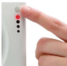
Modèle équipé d'un hygromètre réglable et d'une temporisation automatique, entre 2 et 20 minutes. La sélection de la valeur de consigne se fait par impulsion sur le bouton de façade à 60, 70, 80 ou 90%HR. Un fois ajustée la valeur de consigne, l'aérateur se mettra automatiquement en marche quand l'humidité relative dans la pièce sera supérieure à cette valeur.
