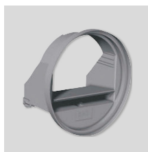
RD BP Regulateurs de débit autoréglables de basse pression (20/100 PA). Ils sont installés dans le conduit. Diamètre 80 mm. Débit: 15 ou 30 m 3 /h.
