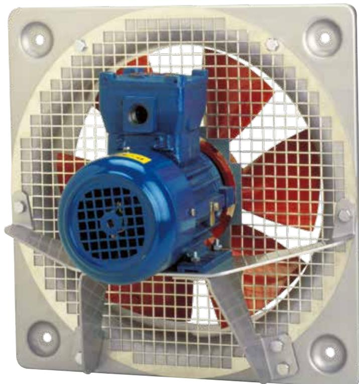
Ventilateurs hélicoïdes muraux conformes à la Directive ATEX. Platine et support moteur en tôle d'aluminium de forte épaisseur. L'ensemble est protégé par une peinture polyester de couleur argent. Hélice à pales fixes en aluminium injecté d'une seule pièce et protégée par une peinture époxy-polyester rouge. L'ensemble pavillon d'aspiration/support moteur/hélice est conçu conformément à la Directive ATEX pour ne pas produire d'étincelle en fonctionnement.
