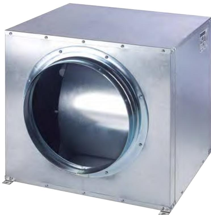
Caissons acoustiques d'extraction et d'insufflation fabriqués en tôle d'acier galvanisée avec isolation acoustique en mousse de mélamine de 7 mm M1. Installation en combles ou en terrasse. Ventilateur double ouïe à entraînement direct fixé dans le caisson sur des plots antivibratiles et boîte à borne séparée IP55. Température de fonctionnement de -20°C à + 40°C.
