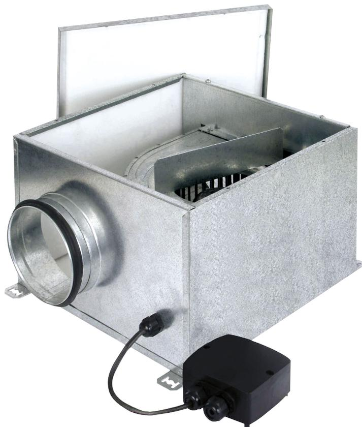
Caissons acoustiques d'extraction et d'insufflation fabriqués en tôle d'acier galvanisée avec isolation acoustique en mousse de mélamine de 7 mm M1. Installation en combles ou en terrasse. Montage horizontal ou vertical. Ventilateur simple ouïe à entraînement direct. Température de fonctionnement de -20°C à + 40°C.
