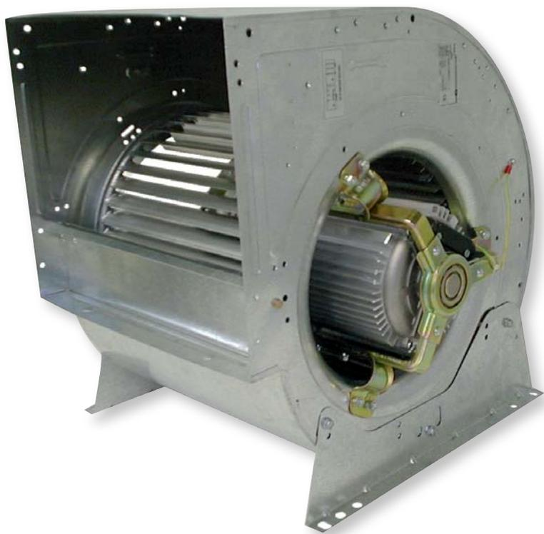
Gamme de ventilateurs double ouïe en tôle d'acier galvanisée. Ils s'incorporent dans les équipements de climatisation et de traitement d'air, dans les caissons de ventilation et dans les hottes de cuisines. Turbine à action en acier galvanisé avec moteur incorporé.
