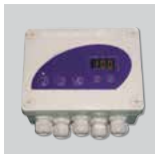
VRPZ Reguladores electrónicos de tensión con display para ventiladores monofásicos 230V, 50/60Hz. Entrada analógica 0-10V ó 4-20mA: El ventilador funciona proporcionalmente al valor de entrada con ajustes de los valores mínimos y máximos de las entradas y de las salidas.
