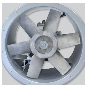
Hélice de aluminio de una sola pieza, equilibrada dinámicamente según norma ISO 14694: G6.3 para reducir ruido y evitar vibraciones.
