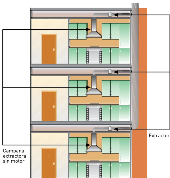
Consiste en la instalación de una campana o grupo filtrante sin motor sobre la zona de cocción y un elemento extractor intercalado en cualquier punto del conducto de evacuación de humos a una distancia de hasta 20 m. La salida de humos puede ser lateral, a un conducto general, o por la cubierta.
