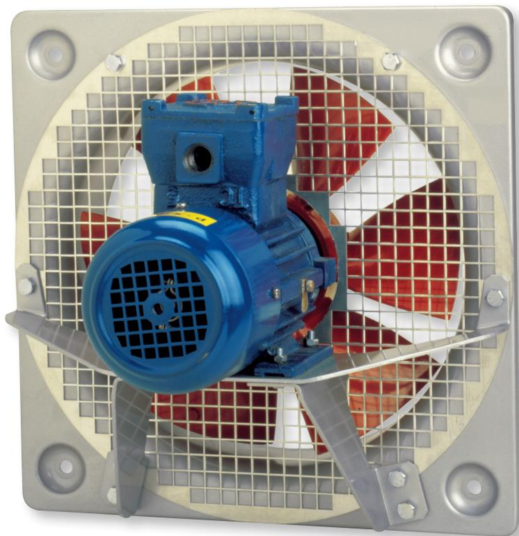
Ventiladores helicoidales murales, especialmente diseñados para la extracción de aire en atmósferas explosivas, con embocadura en chapa de acero galvanizado, anillo interior en aluminio, soporte motor y hélice en aluminio, acabado con pintura gris aluminio B-0920, motor monofásico (HDB) o trifásico (HDT), IP55, Clase F, con rodamientos a bolas de engrase permanente.
