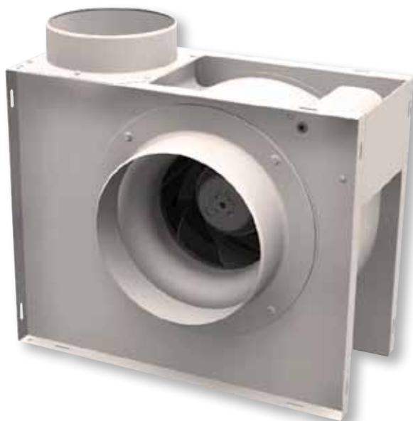
Extractores centrífugos de simple aspiración, fabricados en chapa de acero protegida contra la corrosión con pintura epoxi-poliéster, rodete centrífugo de álabes hacia atrás de alta eficiencia, de material plástico (800 N) o chapa de acero galvanizada (1500 N), bridas circulares en aspiración y descarga, y compuerta antirretorno en la descarga.
