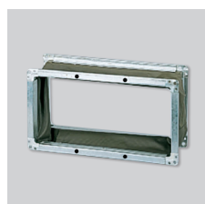
ACOP RECT F400 Acoplamiento elástico rectangular Para instalar en la descarga. Evitan la transmisión de vibraciones. Capacitados para trabajar en condiciones de 400°C/2h.
