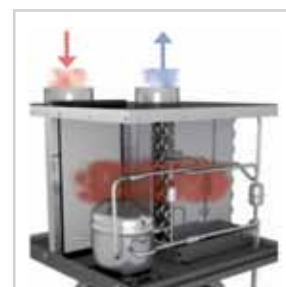
El aire pasa por el evaporador, cediendo sus calorías.
