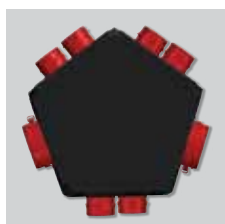
PLENUM UNI EXT 6+1 Plénium aislado de extracción con descarga \varnothing 125/150-160 mm, 1 embocadura para cocina \varnothing 125 mm y hasta un máximo de 6 embocaduras sanitarias \varnothing 80 mm.
