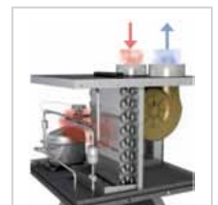
El ventilador extrae el aire hacia el exterior.
