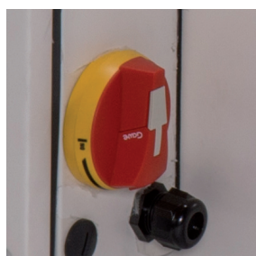
Interruptor de seguridad Todas las versiones incluyen interruptor paro marcha de seguridad.
