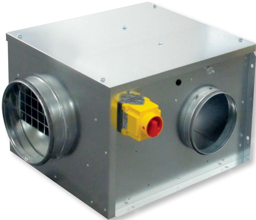
Cajas de ventilación autorregulables, de acero galvanizado, capacitadas para trasegar aire a 400°C-1/2h para la extracción de aire en caso de incendio, equipadas con un ventilador centrífugo de accionamiento directo, con rodete de álabes hacia adelante.
