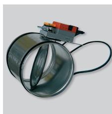
REMP Motorbetätigte Verschlussklappe öffnet proportional und wird vom Steuermodul BEAS gesteuert. Stromversorgung: 24 V AC oder 24 V DC, abhängig von den Modellen.
