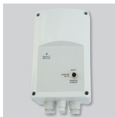
VAPZ Elektronischer Wechselstromregler kon- trolliert die Ventilator-drehzahl mit einem einfachen Kontakt (Präsenzmelder) oder Analogeingang, 0 - 10 V oder 4 - 20 mA (vom Sensor für CO 2 oder relative Feuchte).
