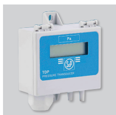
TDP-S / TDP-D / TDP-PI Drucksensor. Dient zur Steuerung des Drucks am Ventilatoreinlass. Druckbereich: 0 - 2500 Pa. Ausgangssignal: 0 - 10 V / 4 - 20 mA.
