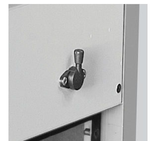
8 Druckanschluss Vor und nach den Filtern zur Kontrolle der Verschmutzung.
