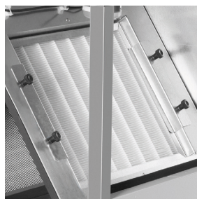
6 Hocheffiziente Filter – Niederdruckfilter F7 (ePM1 70 %) für die Zuluft. – M5-Filter (ePM10 50 %) für die Abluft. Möglichkeit der Montage eines zweiten Filters im Inneren des Geräts (Zubehör). Druckwächter inbegriffen.
