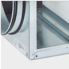
Stabile Ausführung, gute Dämmung Konstruktion aus Sandwichplatten mit feuerfester Dämmung (A1/M0) 25 oder 30 mm Dicke, Modellabhängig.
