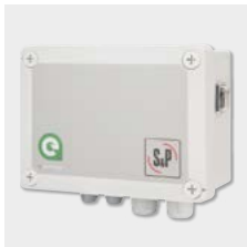
CONTROL ECOWATT BASIC wandelt bis zu drei digitale Eingänge in ein beliebig einstellbares 0-10 V Signal um, zur stufenigen Drehzahlregelung von EC-Ventilatoren und Frequenzumrichtern.
