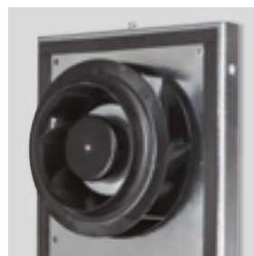
Waaier met achterover gebogen schoepen Om vuilophopingen te voorkomen. Dynamisch uitgebalanceerd. Waaier van kunststof voor maten 180 en 200, van aluminium voor 225 en 315 A.
