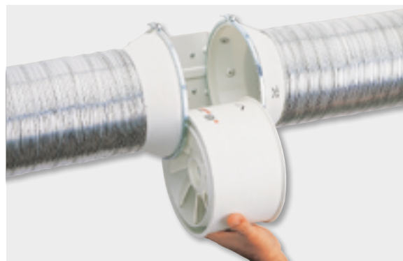
Dankzij het unieke ontwerp van de steunbeugel kan de motor en waaier geplaatst of verwijderd worden zonder de aangrenzende leidingen uit te bouwen.
