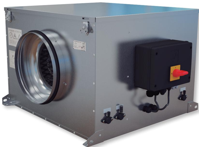
Gamme de caissons d'extraction ou d'insufflation, en tôle d'acier galvanisé incorporant une isolation acoustique (M0) en fibre de verre ininflammable de 50 mm à l'aspiration et au soufflage. Les caissons sont pourvus de brides circulaires en ligne avec joint caoutchouc pour l'étanchéité. Turbine centrifuge à réaction.
