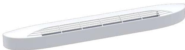
Les entrées d'air **ISOLA** se posent en applique sur la menuiserie, sur réservation de **354 x 12 mm**.
