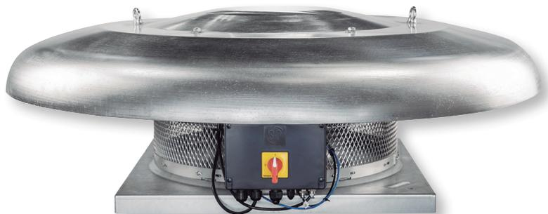
Tourelles centrifuges de toiture à profil bas, auto-régulés, à rejet horizontale, composés d'un moteur à courant continu (DC), d'une roue centrifuge incurvée vers l'arrière, d'une grille de protection contre les oiseaux, d'une base en acier galvanisé, d'un couvercle en aluminium et d'un interrupteur marche/arrêt.
