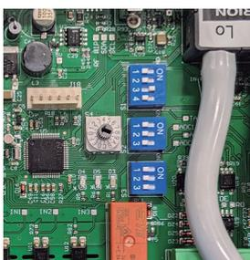
**L'ÉLECTRONIQUE ECOWATT PLUS** permet d'ajuster les paramètres et de modifier les modes de fonctionnement grâce à un potentiomètre et des relais.
