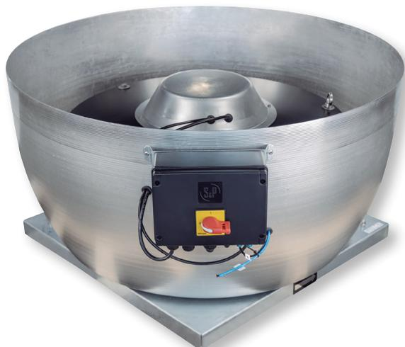
Tourelles centrifuges de toiture à profil bas, auto-régulés, à rejet vertical, composés d'un moteur à courant continu (DC), d'une roue centrifuge incurvée vers l'arrière, d'une grille de protection contre les oiseaux, d'une base en acier galvanisé, d'un couvercle en aluminium et d'un interrupteur marche/arrêt.
